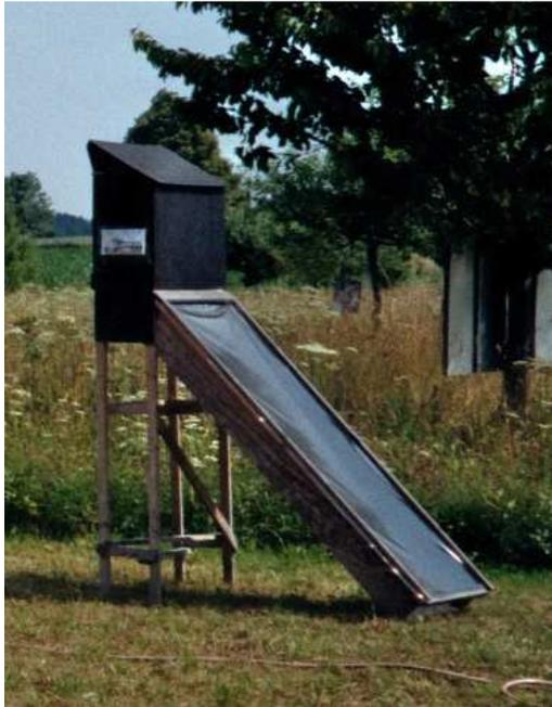
*Abb. Solardörngerät: die schwarze Schräge heizt sich durch die Sonne auf und die bis zu 55°C warme Luft streicht an dem Dörrgut in der oberhalb gelegenen Kammer vorbei. Zwei bis drei Sonnentage genügen, um Apfelringe zu trocknen. Das Gerät ist auch für Kräuter, Tomaten etc. geeignet. Anfragen zum Bezug des Gerätes an: Andreas Huber, Gessenberg 3, 83329 Waging, Tel. 08681/45408.*
