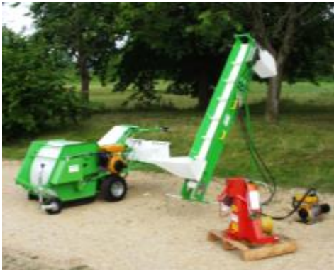
Handgeführte Sammelmaschine mit Lade- förderband und Seilschüttler (rechts)
